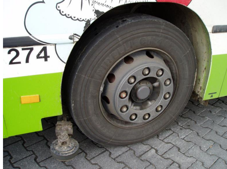
Figura 2.8 - Direção guiada por roda lateral em Mannheim, Alemanha
