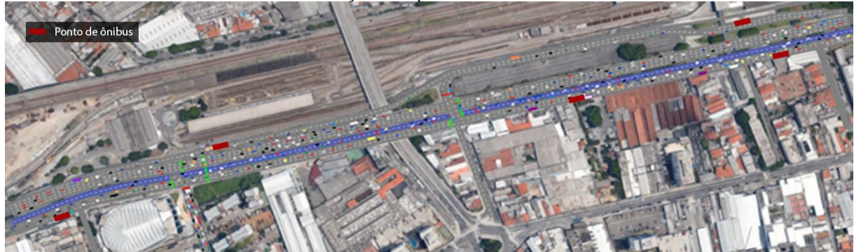
Figura 4.1 – Imagem do modelo operando uma simulação para a situação atual, com destaque para a localização das paradas de ônibus
