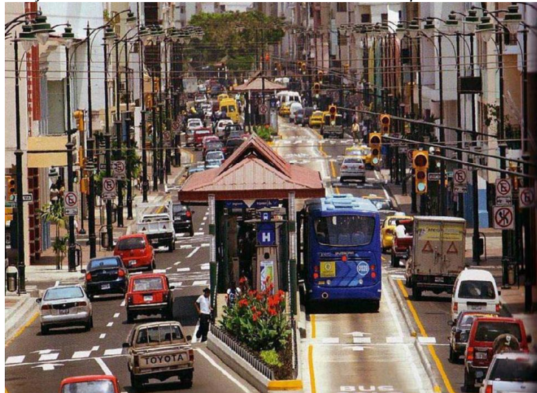
Figura 2.29 - Exemplo de corredores divididos em Guayaquil, que utiliza uma configuração com o serviço em cada sentido acontecendo em uma rua paralela diferente
